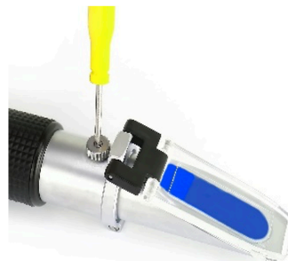
Justieren mit Hilfe der Kalibrierschraube
